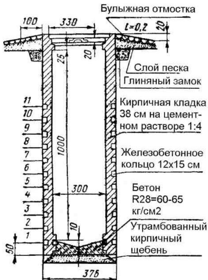
Рисунок 1 – Устройство биотермической ямы
