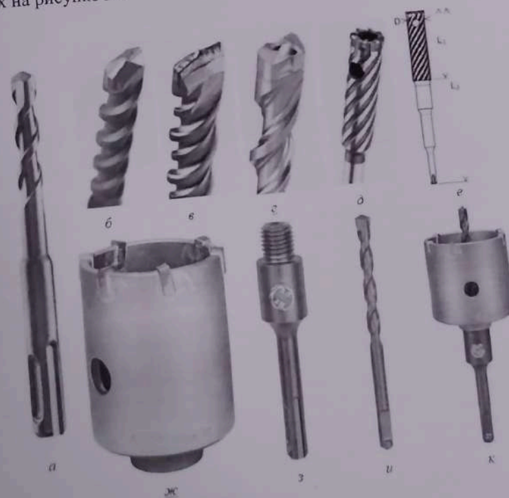
Рисунок 3.2 – Основные типы насадок для перфоратора с хвостовиком
