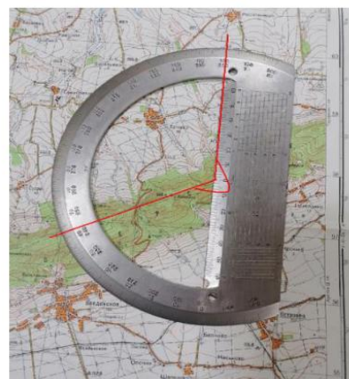
в – положение транспортира (дугой влево) при измерении угла в диапазоне 180^\circ – 360^\circ ; измеряемый горизонтальный угол 244,5^\circ или 244^\circ 30' определяется по внутренней шкале
