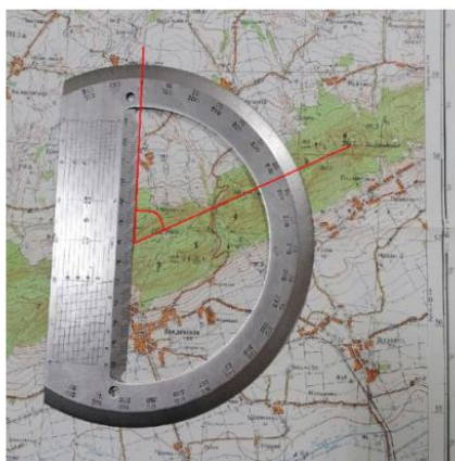
б – положение транспортира (дугой вправо) при измерении угла в диапазоне 0^\circ – 180^\circ ; измеряемый горизонтальный угол 64,5^\circ или 64^\circ 30' определяется по внешней шкале
