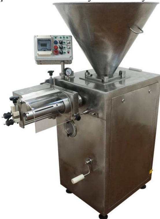
Рисунок 10.3 – Шприц вакуумный шнековый (перекрутчик) ИПКС-047ШП(Н)
