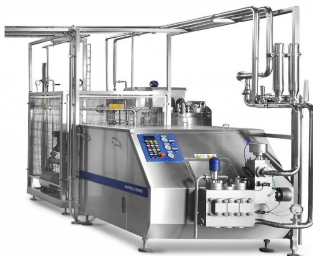
Рисунок 2.5 – Современный гомогенизатор для молока
