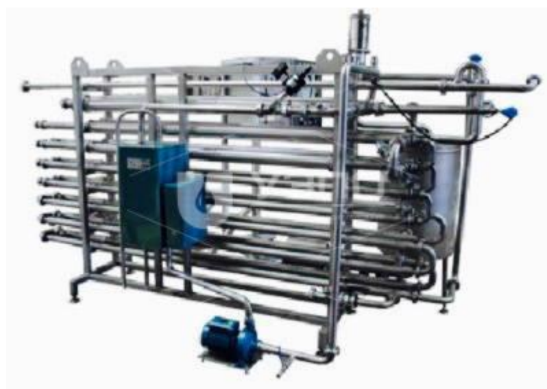
Рисунок 3.3 – Пастеризационно-охладительная установка ПОУ-3000
