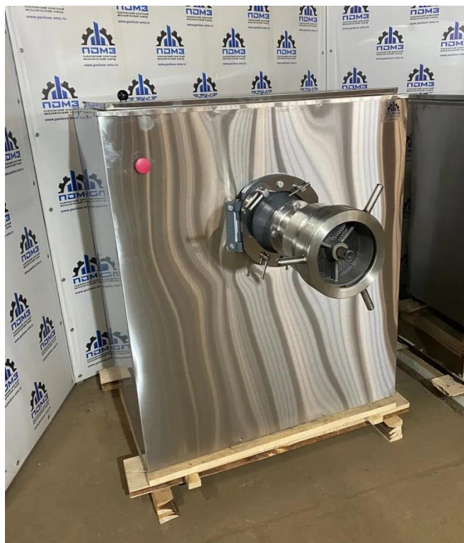
Рисунок 8.2 – Волчок (мясорубка) ВРД 200 А
