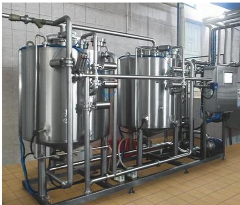
Рисунок 5.6 – Линия по производству творога
