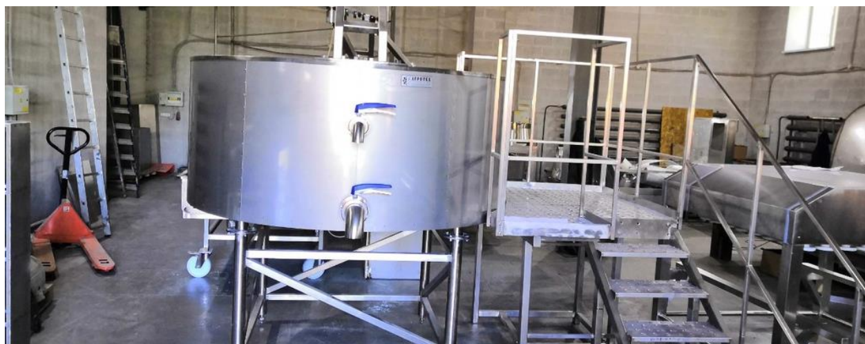
Рисунок 6.3 – Сыродельная ванна компании «Агротех»
