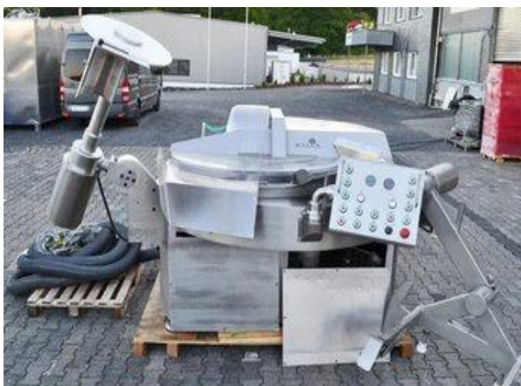
Рисунок 8.12 – Вакуумный куттер Kilia VSK 5000 Express 200
