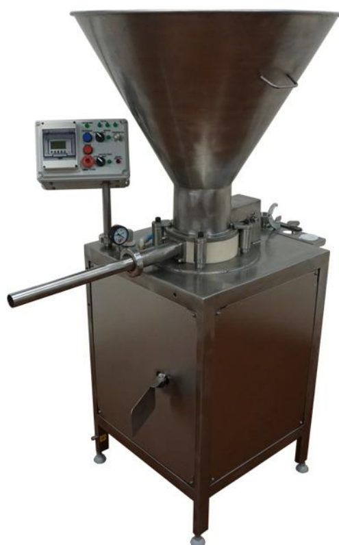
Рисунок 10.4 – Шприц вакуумный (колбасный, дозирующий роторный) ИПКС-047МД(Н)
