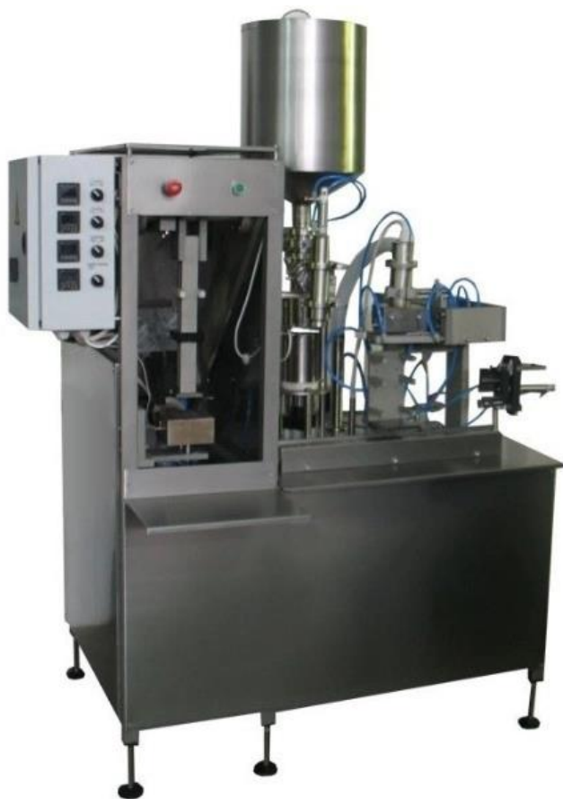
Рисунок 7.1 – Полуавтомат «Альтер-04» для розлива и упаковки в «Пюр-Пак»
