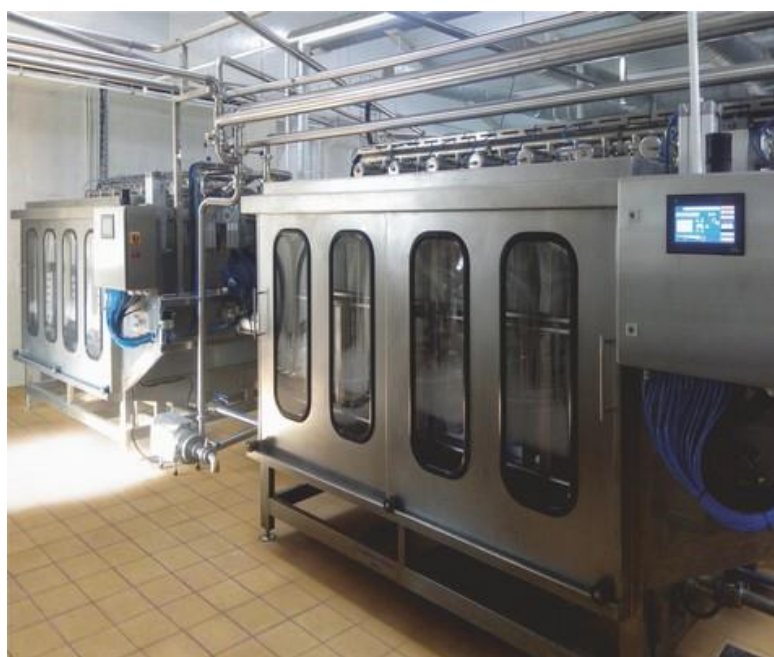
Рисунок 5.5 – Творогоизготовитель и установка прессования творожного сгустка УТС
