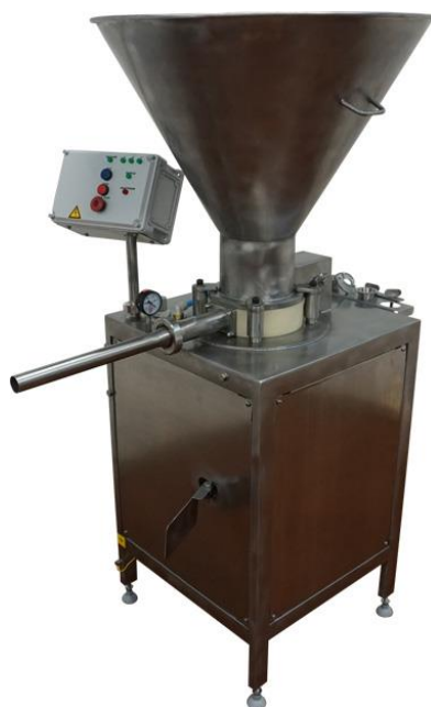
Рисунок 10.2 – Шприц вакуумный (перекрутки для колбас, сосисок, роторный) ИПКС-047МП(Н)
