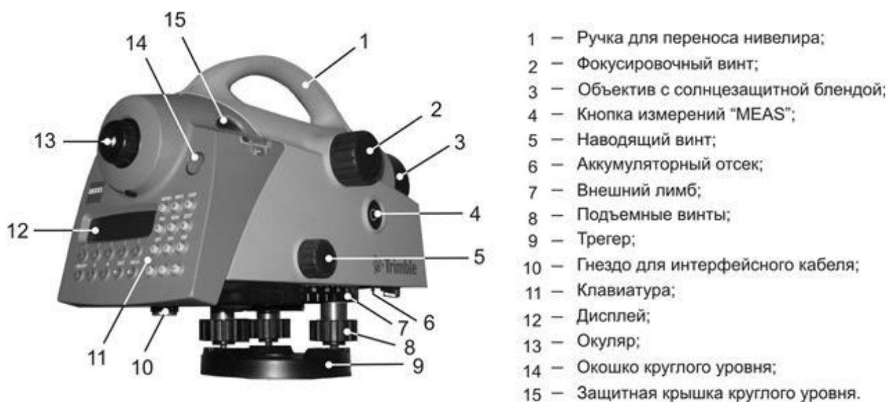
Рисунок 30 – Устройство электронного нивелира Trimble Dini 12
