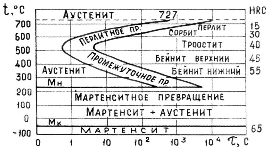
Рисунок 6.1 – Диаграмма изотермического превращения аустенита
