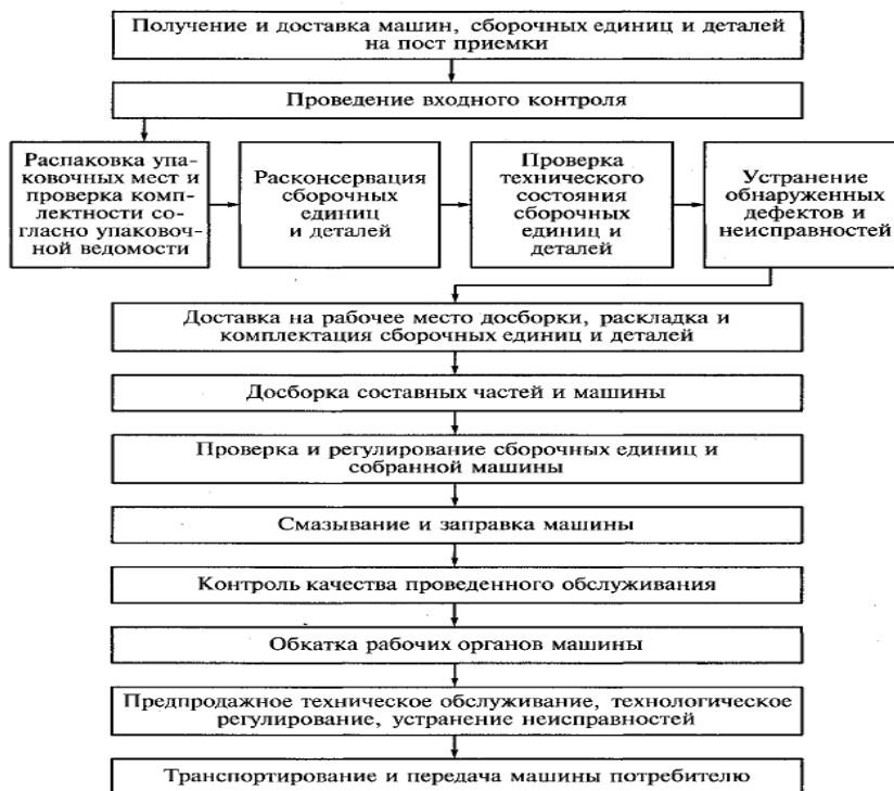
Рисунок 2.2. Схема технологического процесса предпродажного обслуживания машин.
