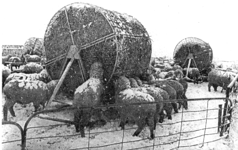
Рисунок 9 – Передвижная ротационная самокормушка для овец
