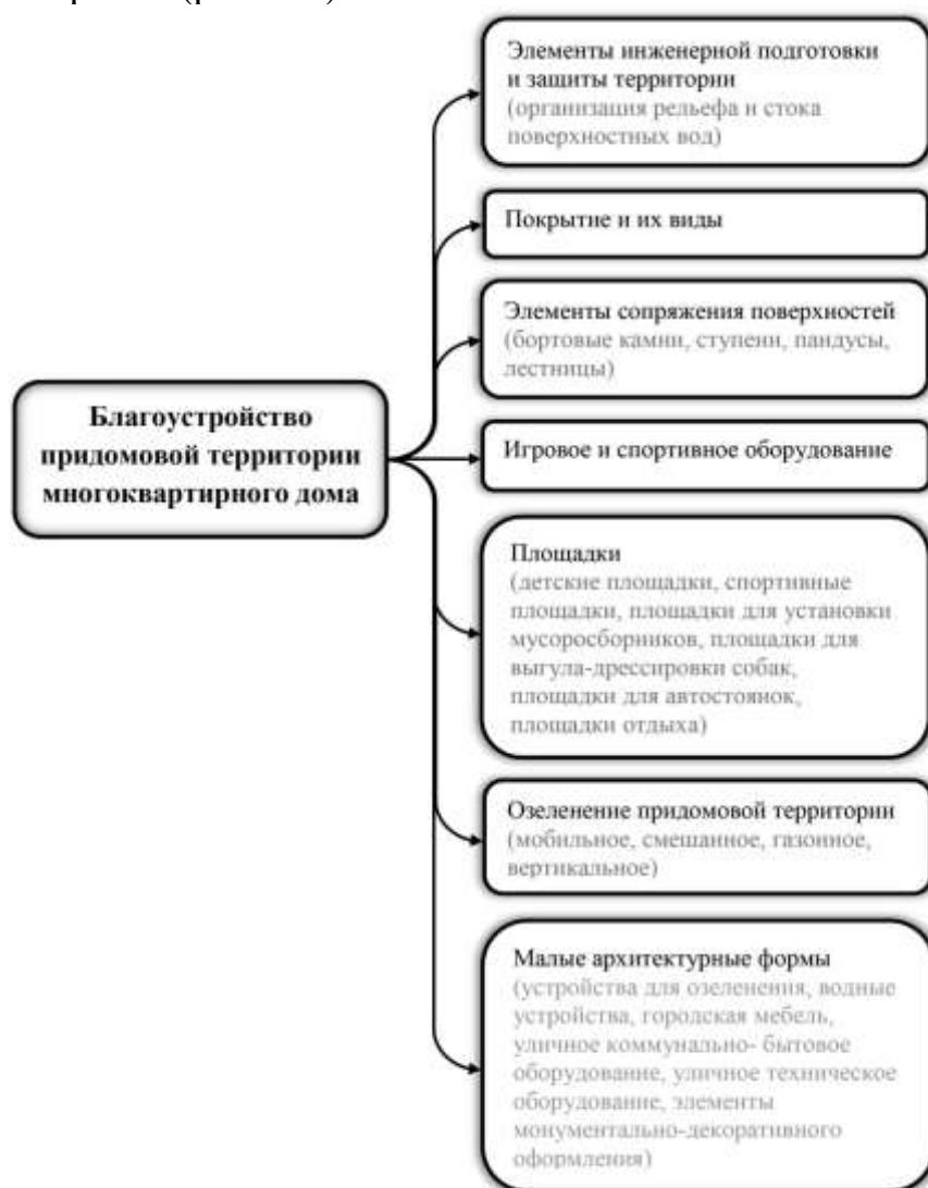
Рис. 1.1. Структура благоустройства придомовых территорий многоквартирного дома
