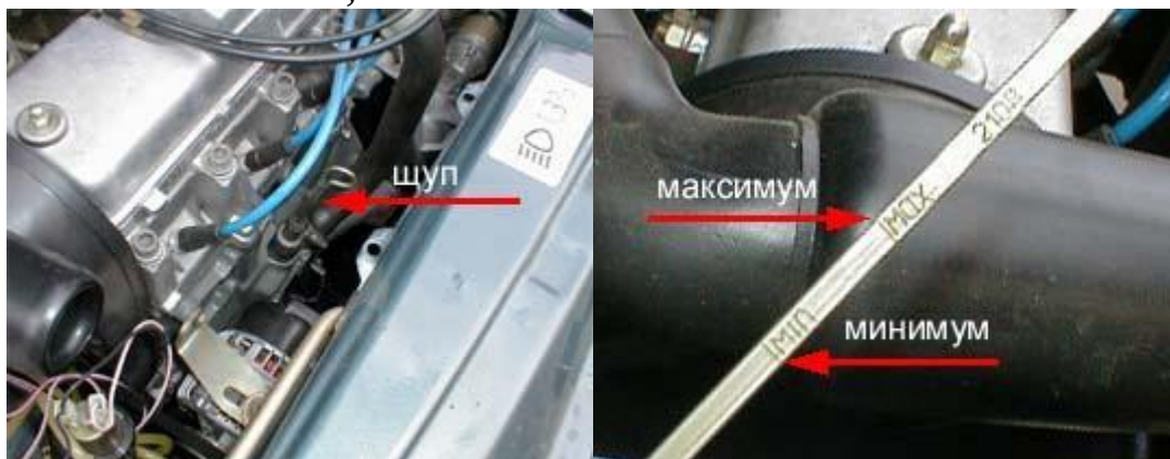
Рисунок 3.1 – Проверка уровня масла
