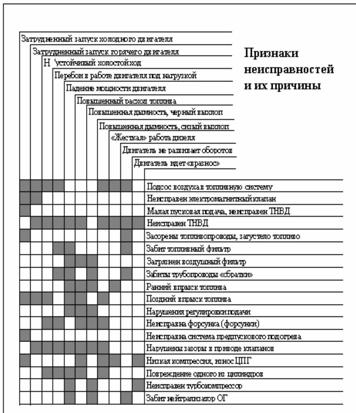
Рисунок 4.1 – Признаки неисправностей дизельных двигателей
