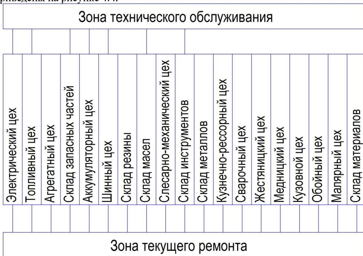
Рисунок 4.4 – Структурная схема комплектования цехов и их связи с производственными зонами
