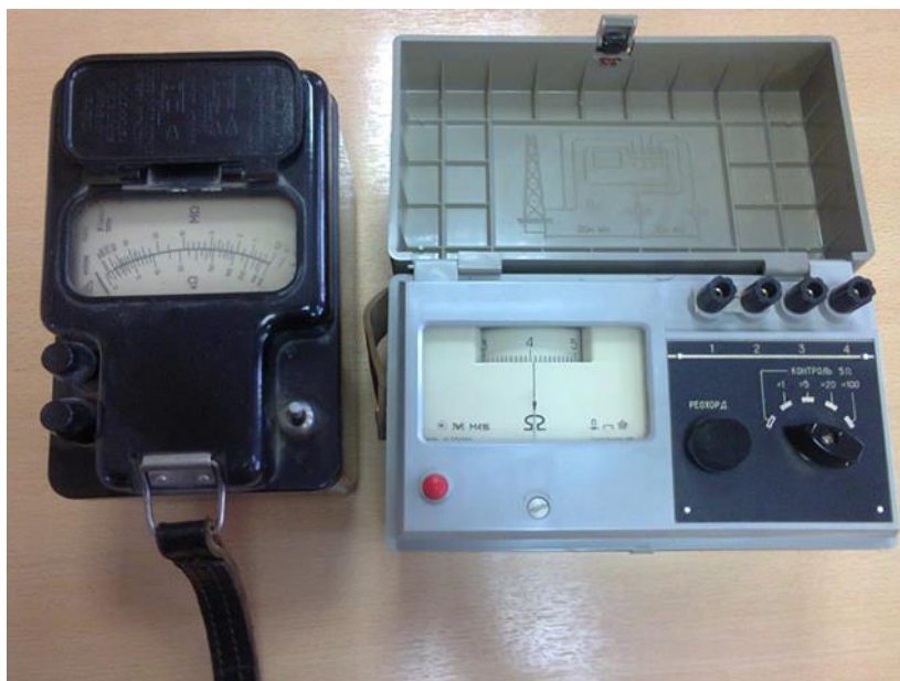
Рисунок 3.2 – Общий вид мегомметров для регистрации параметров заземления и состояния обмоток электроустановок
