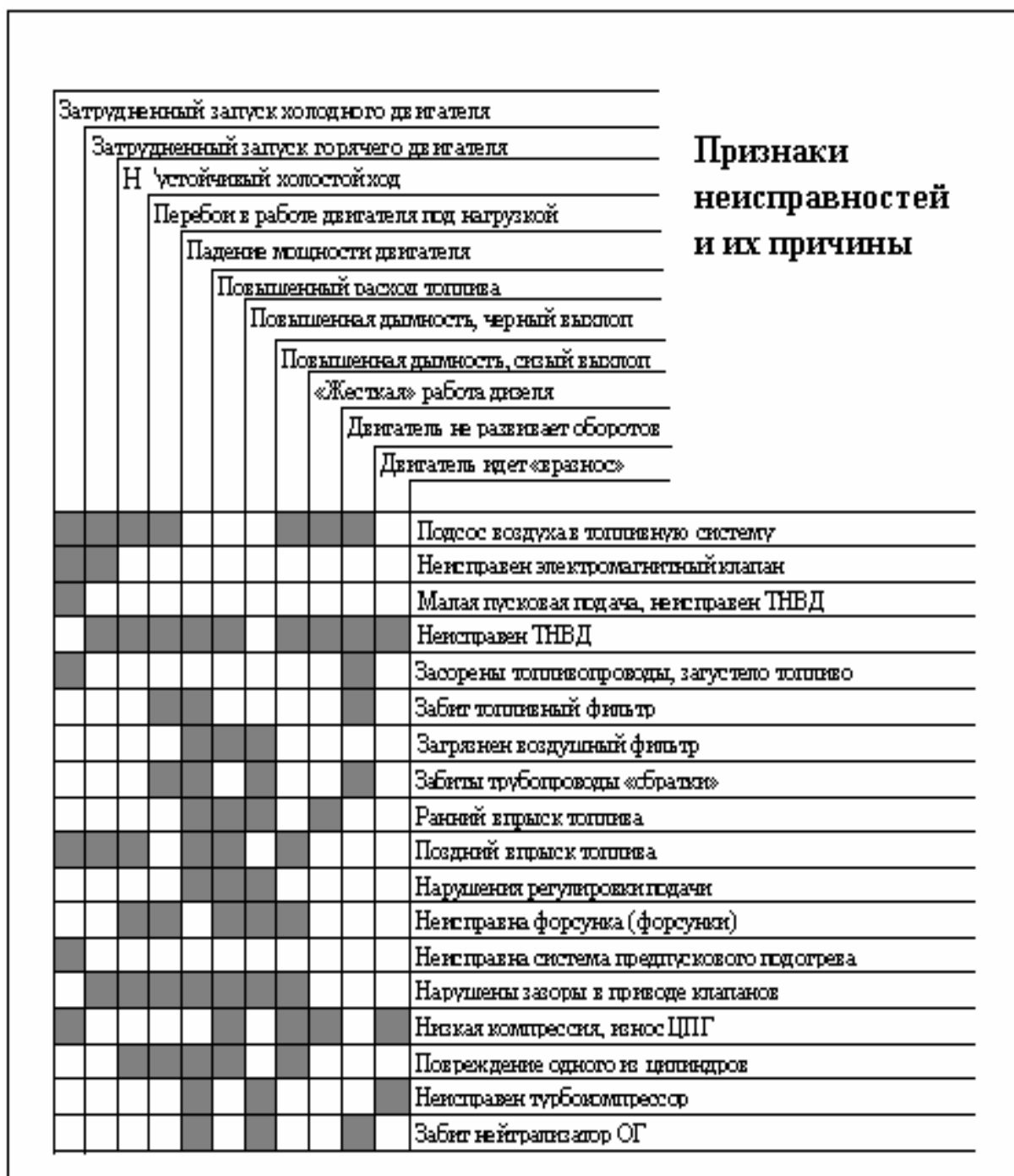
Рисунок 4.1- Признаки неисправностей дизельных двигателей
