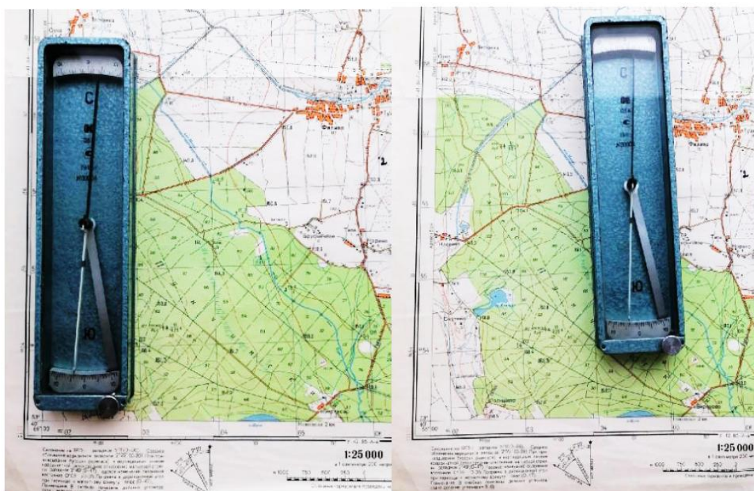
Рисунок 13 – Ориентирование карты с помощью буссоли:
