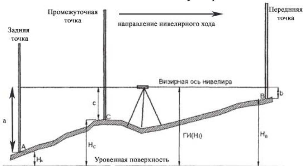
Рисунок 45 – Схема работы с нивелиром на станции (способ нивелирование из середины)
