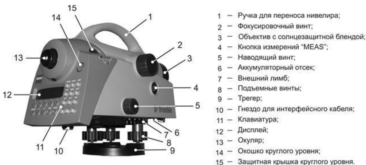
Рисунок 38 – Устройство электронного нивелира Trimble DiNi 12
