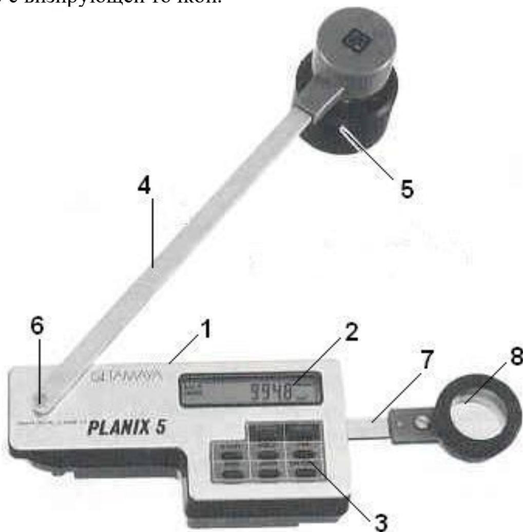
Рисунок 133 – Устройство планиметра «PLANIX 5»: 1 – лицевой корпус; 2 – дисплей; 3 – панель управления; 4 – полюсный рычаг; 5 – груз; 6 – штифт шарнирного соединения; 7 – измерительный механизм; 8 – лупа с визирующей точкой.
