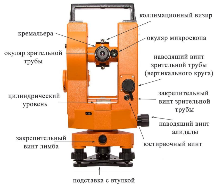
Рисунок 48 – Устройство теодолита 3Т5КП
