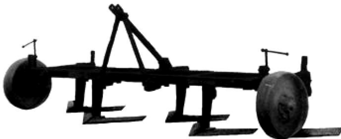
Культиватор плоскорез широкозахватный КПШ-5. Предназначен для паровой и осенней обработки почвы, а также предпосевной обработки почв, лёгких по механическому составу, с максимальным сохранением стерни и других пожнивных остатков на поверхности поля после колосовых и пропашных предшественников.
