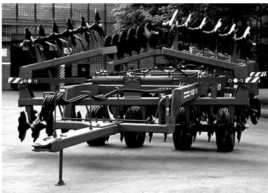
Борона дисковая тяжёлая БДТ-720. Агрегатируется с тракторами К-700.
