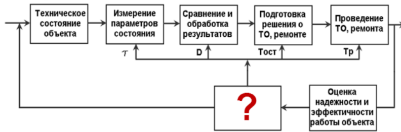
Схема управления техническим состоянием машин; управляющие показатели: \tau – периодичность диагностирования; D – допускаемое отклонение параметра; Тост – остаточный ресурс; Тр – средний ресурс объекта
