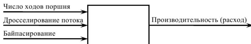
Рис. 2.7. Структурная схема производительности работы поршневых компрессоров.
