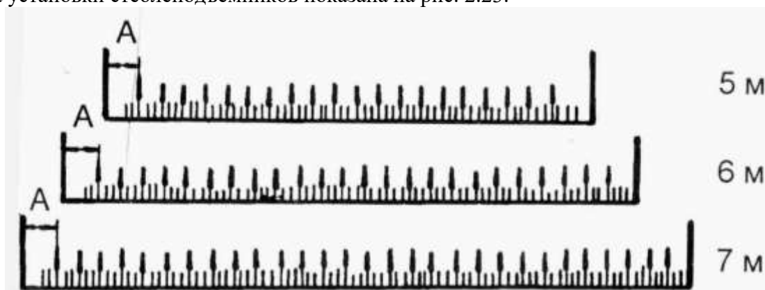
Рис. 2.23. Схема расположения стеблеподъемников: А - расстояние от боковины жатки до оси крайнего левого стеблеподъемника, равное 268 мм
