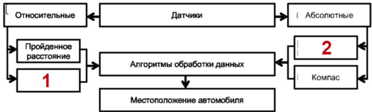
Рисунок – Датчики, используемые для определения местонахождения транспортного средства
