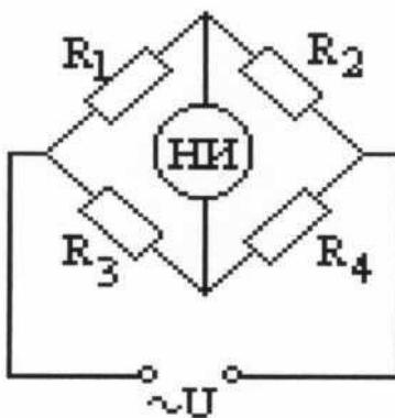
11. На рисунке показана схема уравновешенного моста постоянного тока. Если  $R_2=7$  Ом,  $R_3=5$  Ом,  $R_4=5$  Ом,  $R_1=?$  (7)\*
