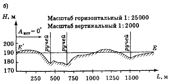
Рисунок 1 – Фрагмент рельефа на топографической карте (а) и профиль рельефа по линии E'E(б)
