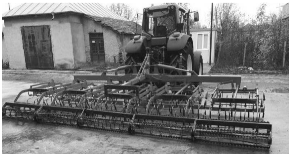
Рисунок 1.3 – Культиватор навесной Korund 8/900 К
