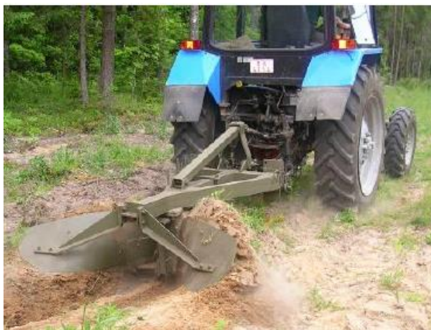
Рисунок 6.7 – Плуг комбинированный лесной ПКЛ-70:
