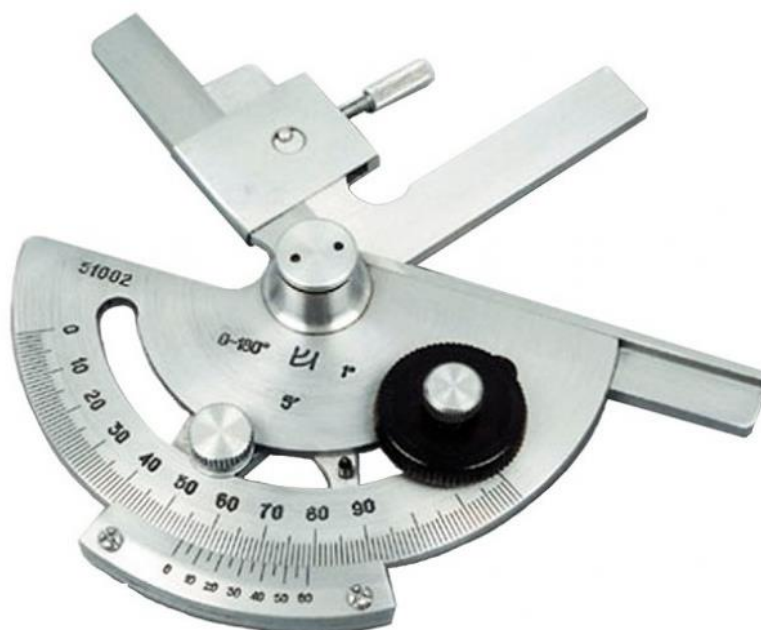
Рисунок 1.27 – Угломер универсальный с нониусом: 1 – сектор-основание; 2 – линейка измерительная; 3 – сектор подвижный; 4 – нониус с ценой деления 5 минут; 5 – фиксатор; 6 – линейка измерительная подвижная; 7 – механизм крепления угольника; 8 - угольник
