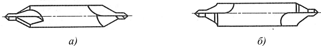
Рисунок 3.27 – Комбинированные центровочные сверла: а – без предохранительного конуса; б – с предохранительным конусом
