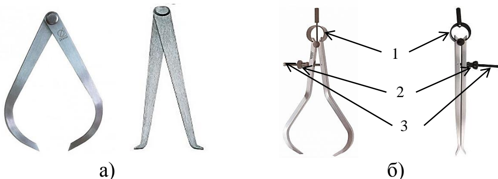
Рисунок 1.14 – Кронциркули и кронциркули-нутромеры: 1- пружина кольцевая разжимная; 2 – гайка регулировочная; 3 - винт
