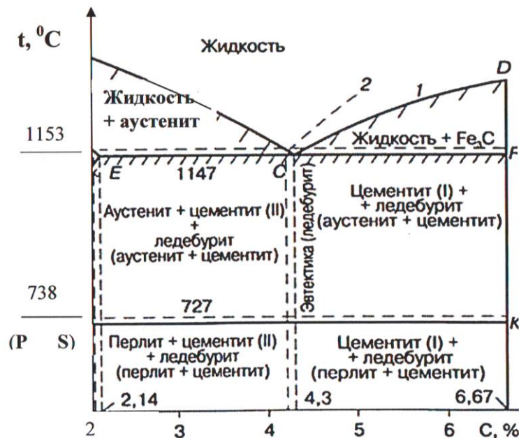
Рисунок 5.1 - Часть диаграммы состояния системы Железо – углерод (чугунный участок)
