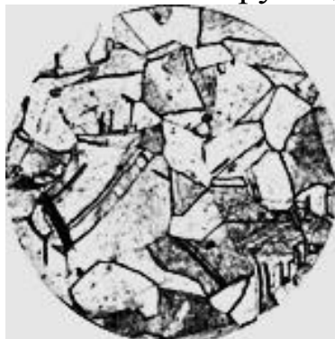
Рисунок 8.1 – Микроструктура меди М1 (травление в 10 %-ом растворе хлористого железа)
