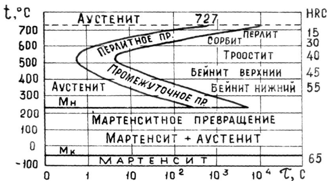
Рисунок 6.1 – Диаграмма изотермического превращения аустенита
